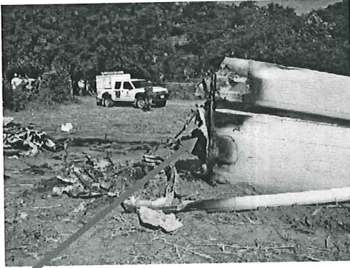
Figura No. 8. Base del plano o ala derecha
